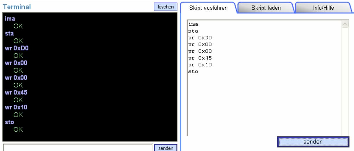
Sie können das Skript auf Wochentag, Tag, Monat und Jahr erweitern. Diese I<sup>2</sup>C Sequenz ist als Initialisierungsfunktion der Echtzeituhr in der zu realisierenden Mikrocontrollerlösung zu implementieren.
