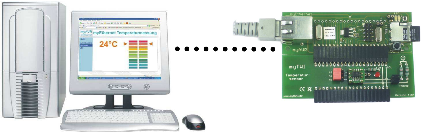
Abbildung / picture: myEthernet mit dem myTWI Temperatursensor LM75, Temperaturanzeige im Internet Explorer myEthernet with the myTWI temperature sensor LM75, temperature gauge by Internet Explorer
