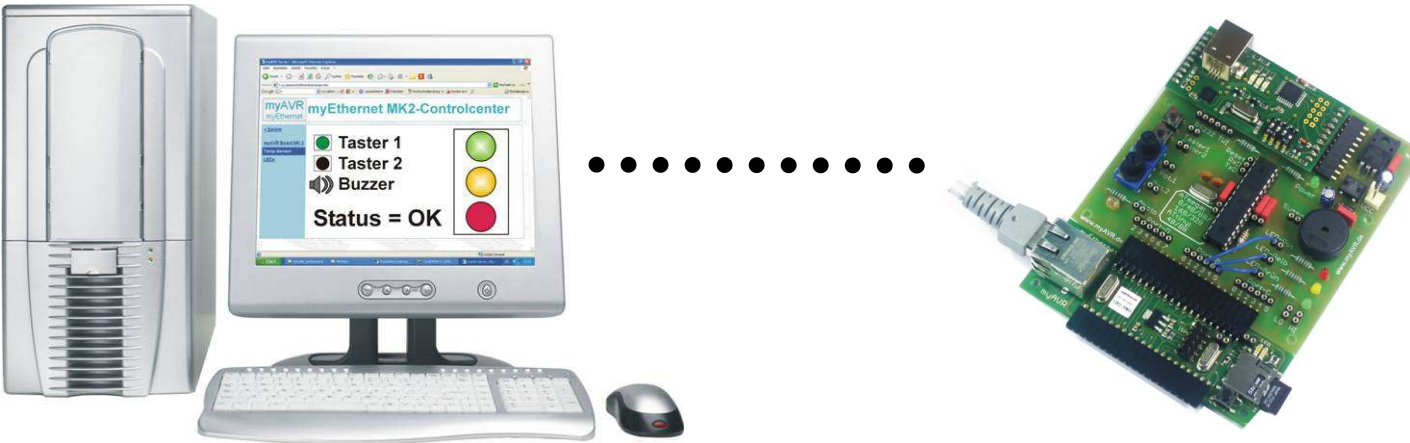
Abbildung / picture: myEthernet am myAVR Board MK2 USB, Statusübermittlung und Visualisierung im Internet Explorer myEthernet at the myAVR Board MK2 USB, status display by Internet Explorer
