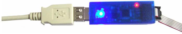
mySmartUSB light mit USB Verlängerung zur Verwendung am PC und ISP Kabel /
